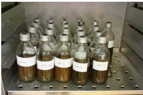
Figur 3.5.1. Glasflaskor som användes under satsvisa rötningsförsök.
